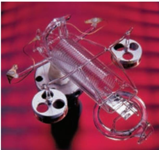
7250LP は独自のクォーツブルドンセンサーを搭載しています。この頑丈なトランスデューサーは、比類のない精度と、1 年で読み値 0.0075 % の安定性を提供します。機械的な結合やダイアフラムをなくし、媒体とクォーツを直接接触させることで、自動制御装置で最高の性能を発揮します。
