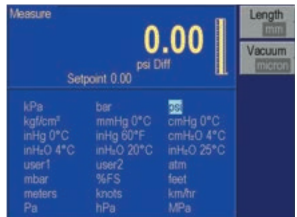
大きいカラーディスプレイは、上に表示されるユニット・セレクション・スクリーンのようなサブメニュー・セレクションを見ている時でも、圧力値を表示することを可能にします。
