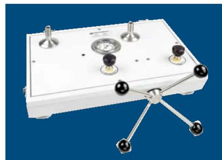
メモ: 通常の機器の使用には窒素ボンベ等の圧力供給源が必要です。オプションで搭載されるハンドポンプとスクリュープレスでは最大3.5 MPaまでです。(負荷容積に依存)
