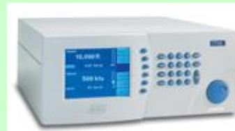
RUSKA の 7750 オートキャルエアデータテストセットは、ピトー静圧はもちろん、エアデータコンピュータ、高度計、エアスピード・上昇率・キャビン内圧などエアデータテストセットの様々な校正要求に対応した自動圧力コントローラです。本体には RUSKA が誇る水晶ブルドン管式基準圧力センサーを搭載。0.005% rdg. の高精度によって RVSM の校正を可能にしています。
