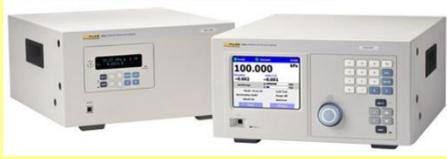
DHI の PPC シリーズ圧力コントローラ/校正器は、幅広いラインナップによって±15kPa の微差圧から 200MPa の高圧までカバーします。独自のポジティブシャットオフ圧力制御回路とキャラクタライズによって幅広い範囲において極めて微細な圧力制御能力を提供します。特徴的なオープンアーキテクチャにより、内蔵の基準圧力センサーだけでなく外部に設置された基準圧力センサーによるフィードバック制御も可能です。
