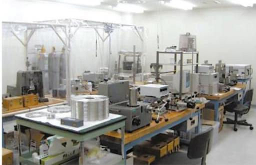
校正サービスを提供する校正サービスグループは、自然の豊かな霞ヶ浦の近く、校正環境として最適な茨城県かすみがうら市に位置しており、校正専用の精密計測棟は、24時間常に温度と湿度が制御・管理・記録され、また、振動を排除するため、重錘形圧力天びんを設置している部分の基礎を建物基礎と完全に分離した特殊な基礎構造とするなど、最高のコンディションで校正を実施しています。
