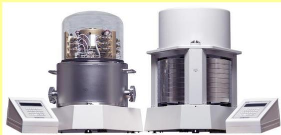
DHI PG7000シリーズは、重錘形圧力天びんとして最高の圧力測定能力を提供します。各国の標準供給機関や校正事業者など最高の校正能力を必要とする機関で数多くの実績を有しています。PG7000シリーズは統合された各種環境測定用センサーとマイクロプロセッサによって計算された圧力をリアルタイムにディスプレイ表示することができます。すべてのPG7000シリーズ、カプセルにモジュール化されたピストンシリンダによって圧力レンジを簡単かつスピーディーに変更することができます。また、自動重錘加除装置 AMH によって、全自動重錘形圧力天びんとして機能することにより、ハイエンドの圧力校正を自動化することが可能です。
