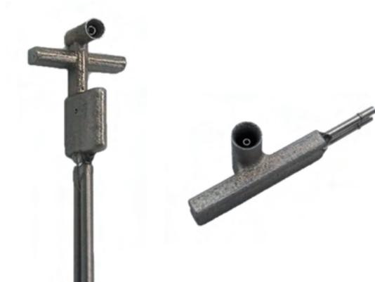
図1：ラジエータープローブのデザイン
