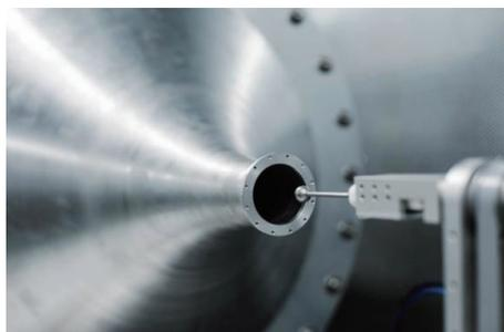
お客様のプローブおよび当社のプローブの流速・流れ角校正サービスを提供しています。これには、熱線プローブが含まれます。キャリブレーション風洞には、3m/sからマッハ2までのフローノズルが装備されています。極超音速領域でのキャリブレーション能力も開発しています。当社の高精度トラバーシステムは、ピッチ角とヨー角の両方で±165の角度範囲をカバーしています。
