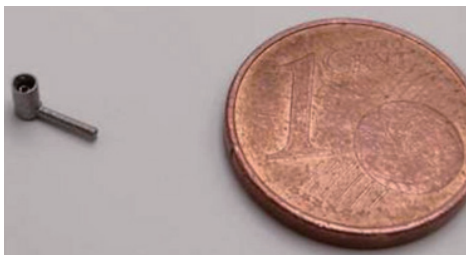
図2. マイクロキールプローブ (Ø 1.6 mm)
