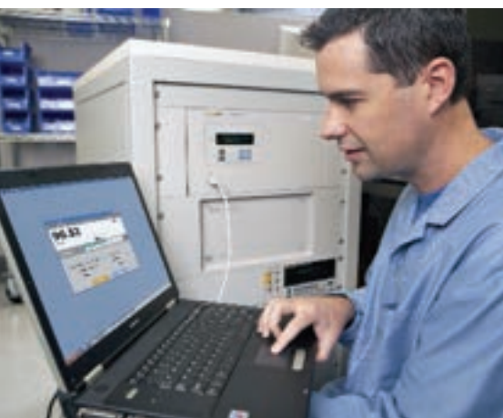
PCをもとにしたプラグ&プレイ機能をフルに使う ためPPC4の標準フロントパネルのUSB接続は 簡易なアクセスを提供
