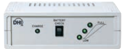
バッテリーパック/充電器。オプションのバッテリーパック/充電器により、E-DWT-Hは電力線がなくても8時間まで遠隔操作が可能です。
