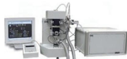
また、重錘形圧力天びんは安定した圧力測定のためにピストンまたはシリンダを回転させますが、とくに微圧領域では、この回転ノイズさえも不確かさの要因となります。FPG8601 は独自の技術により無回転式のピストン・シリンダ構造を実現し、回転ノイズを排除することで微圧範囲を最小の不確かさで定義することができます。
