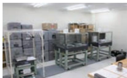
建物、空調設備その他の機器振動を徹底的に排除コンパレータは 350kg 以上の重量をもつ石定盤に設置対流の影響を極力排除するために風防ケースで覆われ、特殊空調と相まって完璧なコンディションを構築。風防は静電気影響を排除するため、ステンレスとガラスで構成されています。
