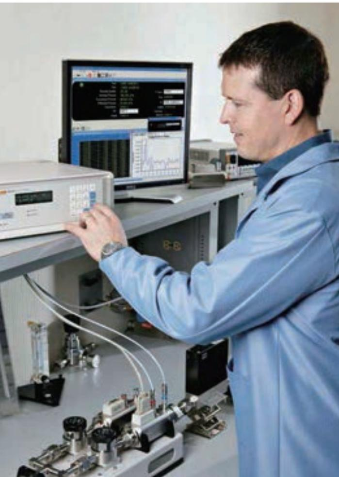
COMPASS は、被測定装置（DUT）のデータを設定し、DUT に測定手順を定義して関連付け、測定を実行し、基準データと測定データを取得し、標準およびカスタムの校正レポートを生成します。
