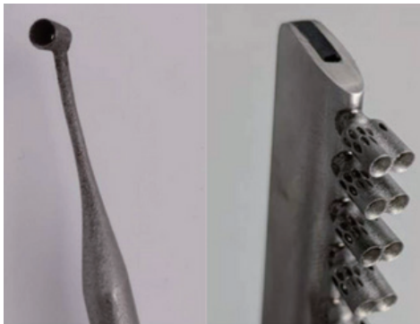
図1. キールプローブ（左側）と複数のキールプローブヘッドが取り付けられた櫛形プローブ（右側）
