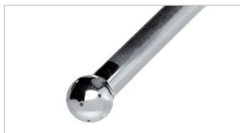
図 1. 14孔 Omni-iProbe 先端部分の拡大図
