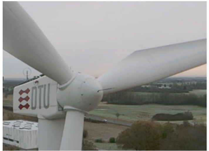
図 3. (写真) デンマーク工科大学にある試験用タービンの先端部に設置されたWindflowerシステム
