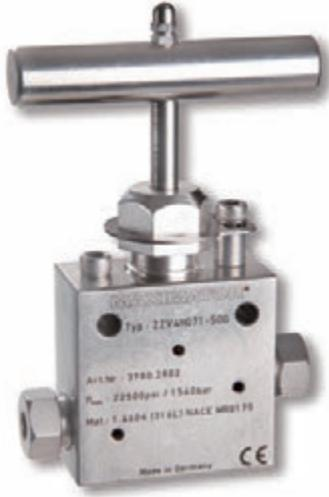
**MAXIMATOR 酸性ガス用バルブ**はH<sub>2</sub>Sが存在するオイルとガス使用用に設計されています。圧力部品の全てはNACE MR0175 の要件に合致する焼き戻し316 ステンレス鋼にて製造されています。メタル-メタルシートを持つこれらのニードルバルブは厳しい使用条件において高いレベルの安全性と信頼性を兼ね備えています。これらのバルブはガスと液体の双方に使用可能です。
