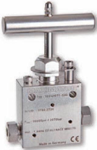
**MAXIMATOR** 酸性ガス用バルブはH<sub>2</sub>Sが存在するオイルとガス使用用に設計されています。圧力部品の全てはNACE MR0175の要件に合致する焼き戻し316ステンレス鋼にて製造されています。メタル-メタルシートを持つこれらのニードルバルブは厳しい使用条件において高いレベルの安全性と信頼性を兼ね備えています。これらのバルブはガスと液体の双方に使用可能です。
